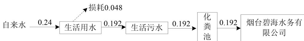
图 2-1 (1) 项目水平衡图 (单位 m³/d)
